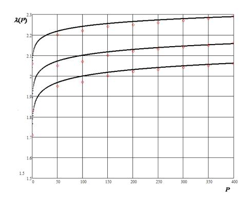
Рис. 2. Зависимость теплопроводности песчаника от давления при постоянной температуре.
