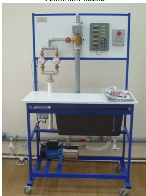
Гидроэнергетическая установка с осевой турбиной.
