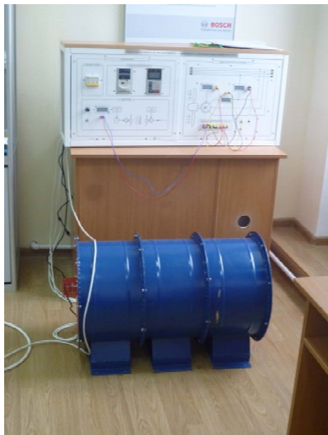
Ветроэнергетическая установка с асинхронным генератором.
