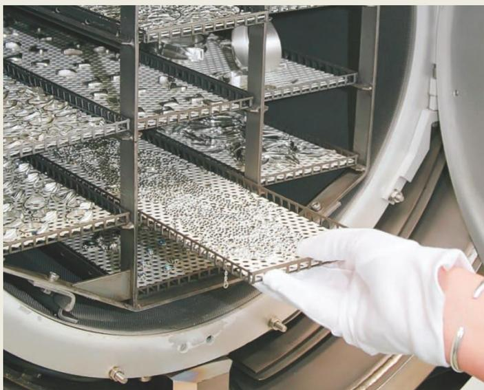
В основе технологии лежит процесс нанесения абсолютно прозрачных, равномерных двухкомпонентных покрытий **ALD**  $\text{Al}_2\text{O}_3$  и  $\text{TiO}_2$ .
