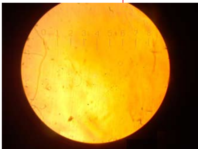
Морфология поверхности пленки теллура, полученной при температуре подложки T_1 = 663\text{K} (x600).
